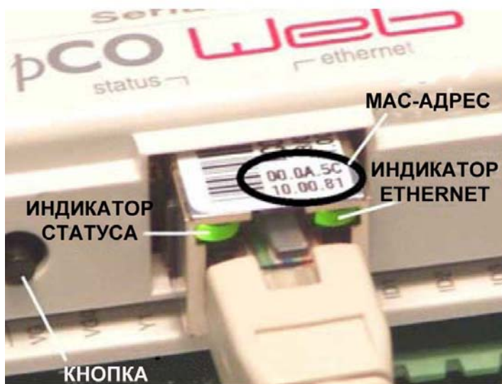
Рис. 1.b — MAC-адрес и светодиодные индикаторы
