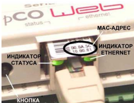
Рис. 2.е – MAC-адрес и светодиодные индикаторы
