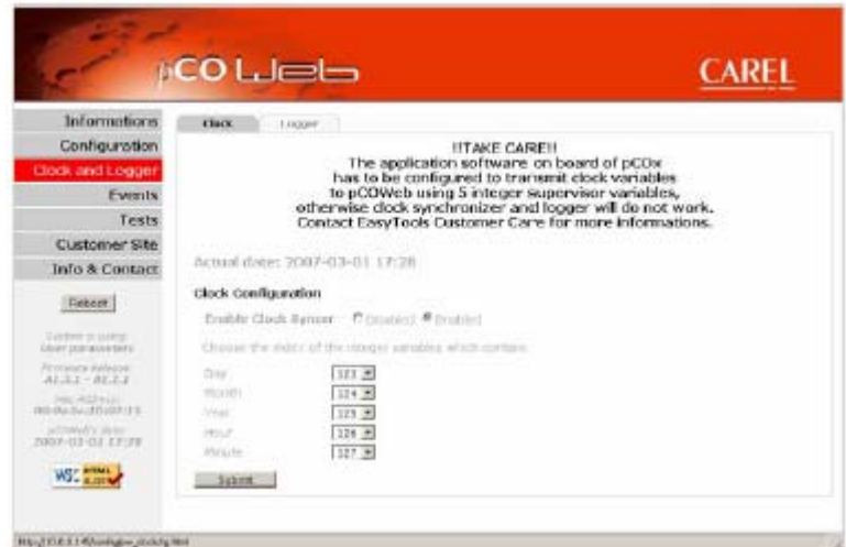
Рис. 8.m – Установка синхронизации часов
