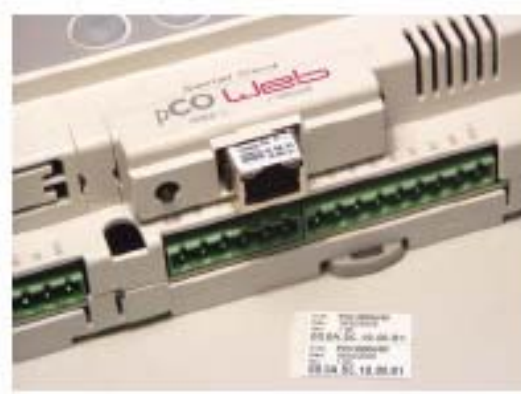
Рис. 2.d — Закрепление устройство pCOWeb с помощью крышки
