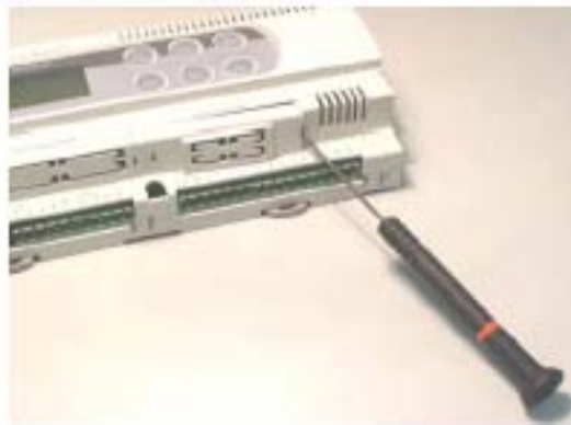
Рис. 2.b — Удаление крышки с контроллера pCO
