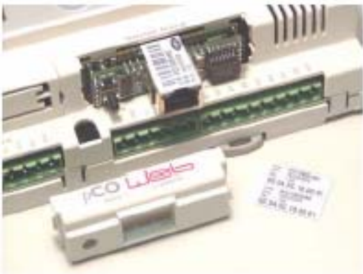
Рис. 2.c — Вставка устройства pCOWeb в контроллер pCO
